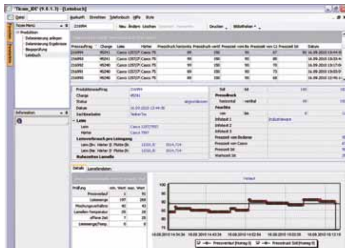
Transparenz auf Knopfdruck: Die gemessenen Produktionsdaten – hier der Pressverlauf – ermöglichen jederzeit Abfragen, Auswertungen oder Analysen
