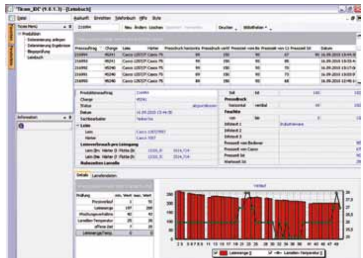
Optimierte Produktion: Der optimierte Leimauftrag wird bei jeder Lamelle genau protokolliert
