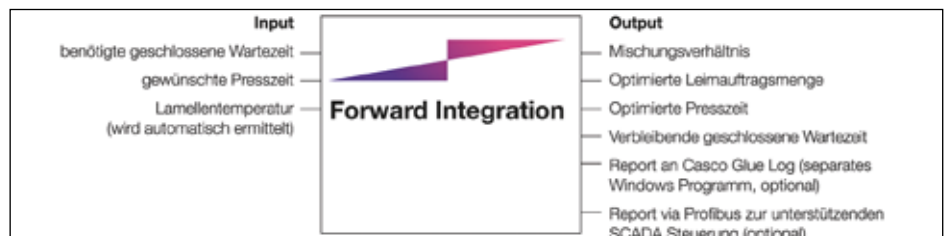
Forward Integration – die Software steuert den Verleimungsprozess in der BSH-Produktion
