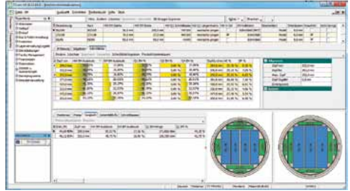
Die TiCom-Schnittbild-Kalkulation berechnet den Erlös auf Basis realer Daten (Rundholzpreis, Vermessungsdaten, Sägelinien-Parameter)
