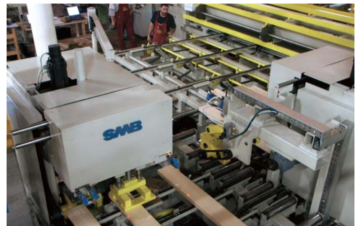
Beide Multi-Taktzentren samt Kran für Werkzeugwechsel
