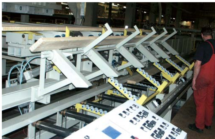
Einer der beiden in Reihe geschalteten Gütesortierplätze
