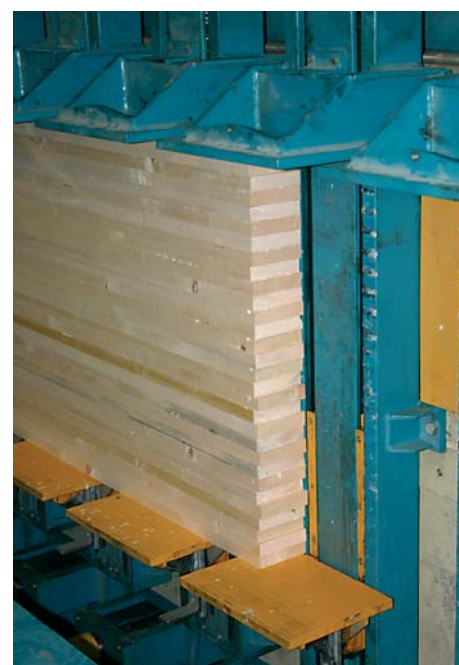
Ledinek-Lösung: Sitzt das Ende der Ware nicht ganz auf, Druckverminderung
