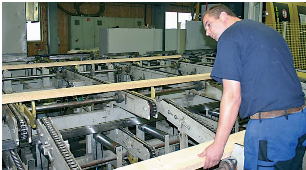
Holzfehler werden visuell aufgespürt und markiert „Besser als der beste Scanner“, so Geschäftsführer Ferdinand Schneider
