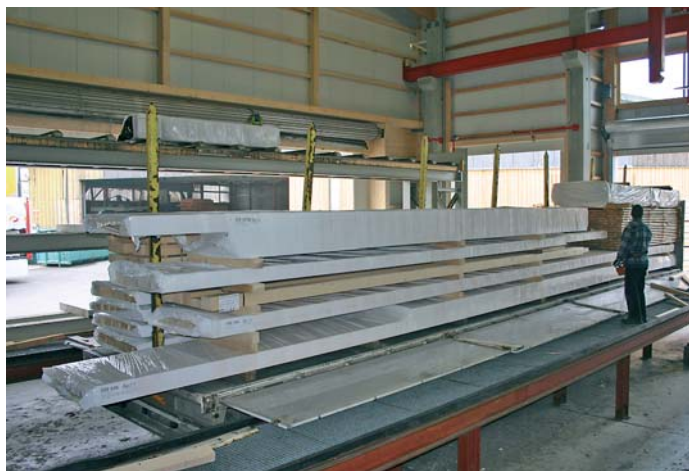
Lkw-Verladung à la Schneider: Mitarbeiter braucht die Pakete vom Rollengang nur noch aufladen
