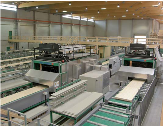
Die beiden Hochfrequenzpressen mit einer Pressfläche von 6000 mal 1280 mm stammen von Kallesøe
