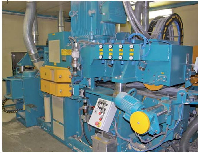
Lamellen-Kalibrierfräsmaschine Rotoles 300 4V-KS200 von Ledinek sorgt für eine gute leimfähige Oberflächenqualität
