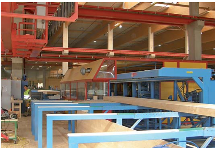
Abbandanlage K3 von Hundegger wurde in die Kommissionierung integriert
