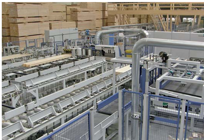
Auf der Grecon-Keilzinkenanlage werden Lamellenlängen bis zu 27 m produziert
