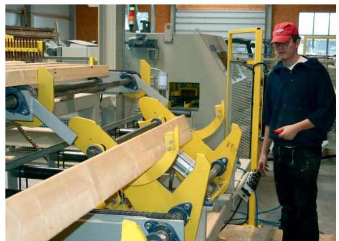
Zur Markierung für die Kappsäge wird das Kantholz mit der SMB-Wendesichel per Knopfdruck gedreht, um die Fehlstellen besser erkennen zu können
