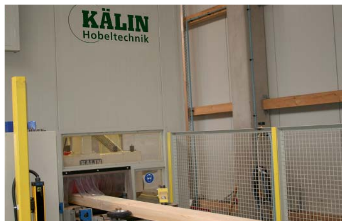
Perfektes Hobelbild war man in Schweich gewohnt – nun lassen sich auch KVH-Stangen mit einem Kälin-Hobel finalisieren
