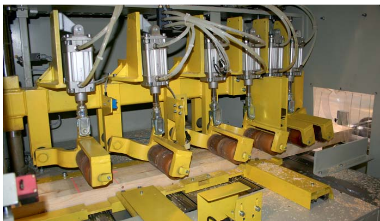
SMB-Kappsäge ist wie die Keilzinkenanlage mit einer motorischen Breitenverstellung zum schnellen Dimensionswechsel ausgestattet
