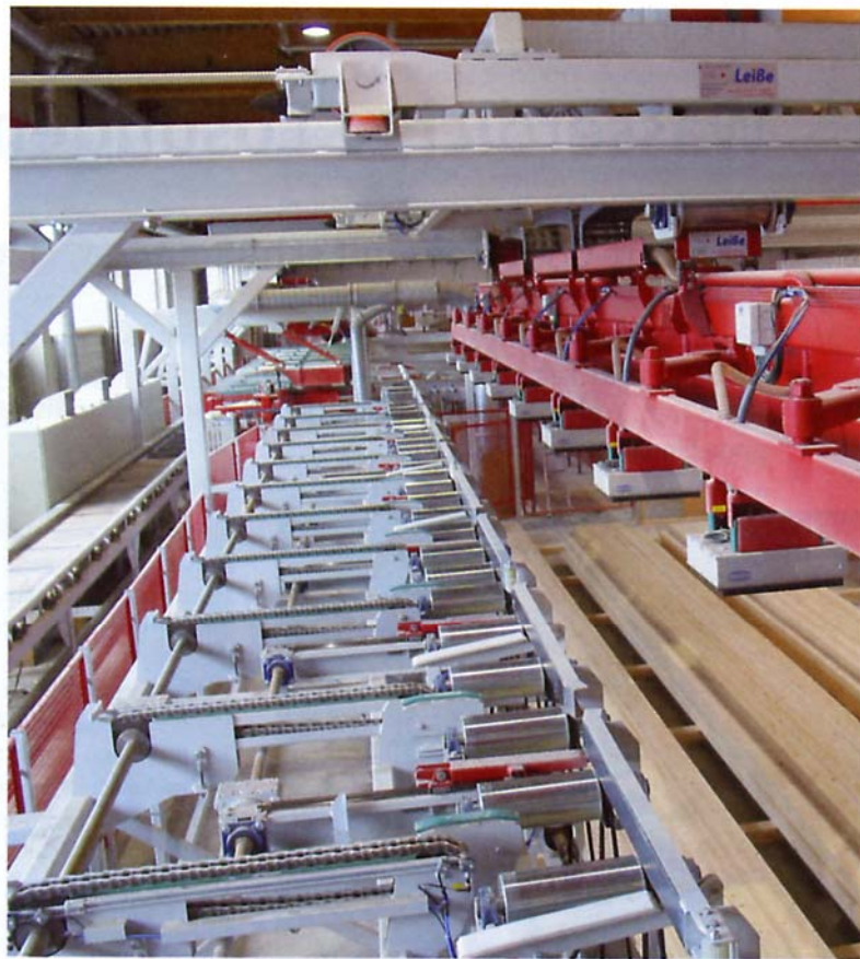
Großes, gestapeltes Zwischenlager nach der Finalhobelmaschine bei Hüttemann in Wismar
