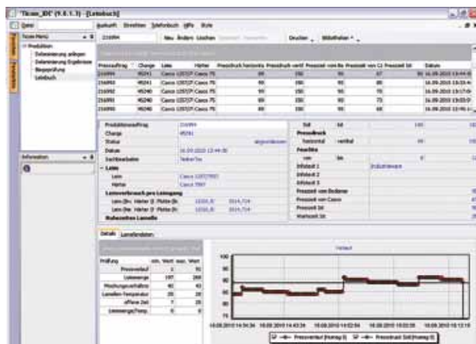
Transparenz auf Knopfdruck: Die gemessenen Produktionsdaten – hier der Pressverlauf – ermöglichen jederzeit Abfragen, Auswertungen oder Analysen
