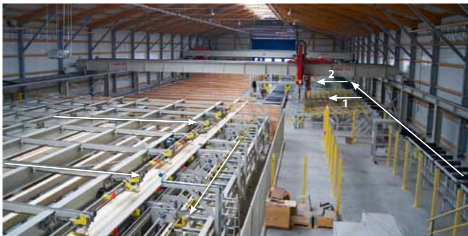
Links härtet KVH im Querlager aus , strömt dann zu Hobelanlage und Kappsäge (nicht im Bild), um anschließend zur Einzelkommissionierung (1) oder direkten Paketbildung (2, s. Bild re.) zu kommen
