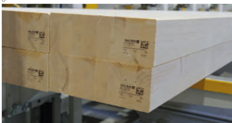
Die Pakete werden vollautomatisch zusammengelegt, die Teile beschriftet, gebunden und foliert.
